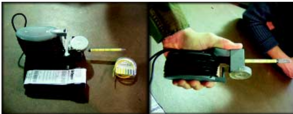
Fot. 13. Tester do badania zawartości hydrazyny w powietrzu (Draeger Tester) i papier lakmusowy
