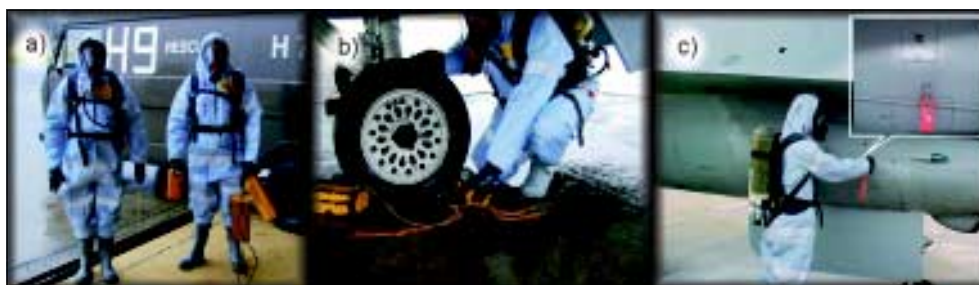
Fot. 8. Hydrazine Response Team: a) członkowie zespołu HRT gotowi do pracy, b) zabezpieczanie podwozia, c) zakładanie zabezpieczenia naziemnego (safety pin) instalacji EPU
