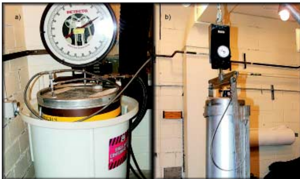
Fot. 5. Obsługa zbiorników hdrazyny: a) kontrolowanie ubytku (stanu napełnienia) hydrazyny za pomocą wagi laboratoryjnej (metalowa beczka z hydrazyną umieszczona jest w kontenerze z tworzywa sztucznego), b) ważenie pokładowego zbiornika hydrazyny (określanie zawartości hydrazyny)
