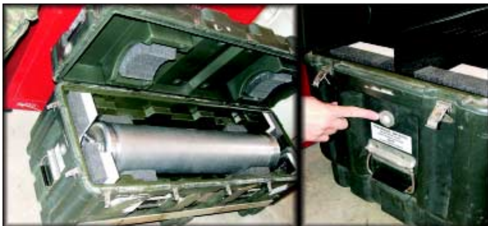
Fot. 6. Pokładowy zbiornik hydrazyny przechowywany w specjalnym, przenośnym, szczelnym kontenerze. Na zdjęciu po prawej stronie kontener z widocznym znacznikiem – sygnalizatorem wycieku hydrazyny wewnątrz kontenera, poniżej znacznika tabliczka informacyjna
