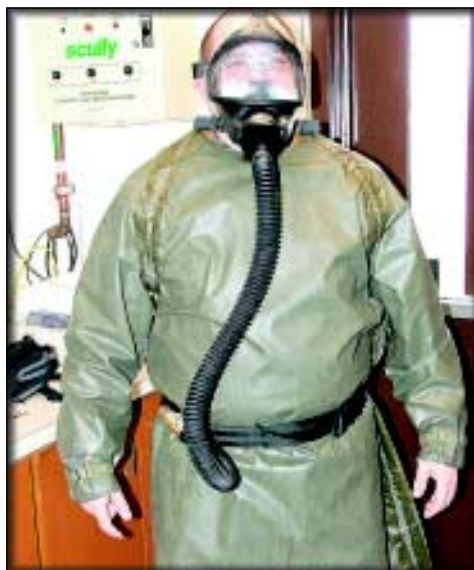
Fot. 4. Ubiór ochronny personelu magazynu hydrazyny (w zestaw wchodzi również rękawice i kaptur) służący do wykonywania obsługi zbiorników hydrazyny
