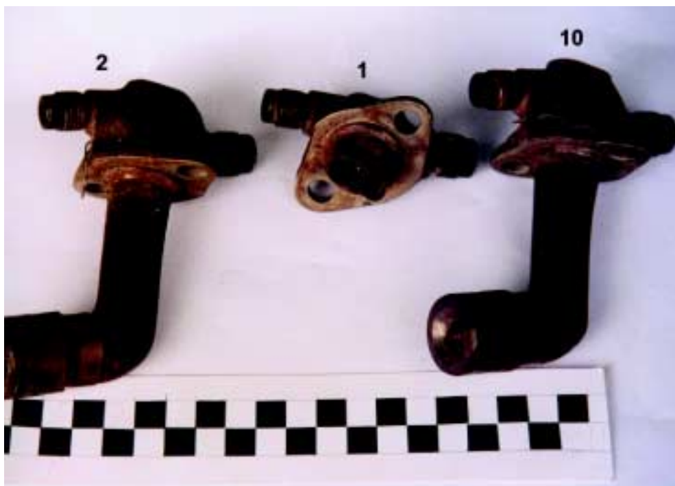
Fot. 4. Wtryskiwacze robocze z wypalonych rur żarowych komory spalania silnika
