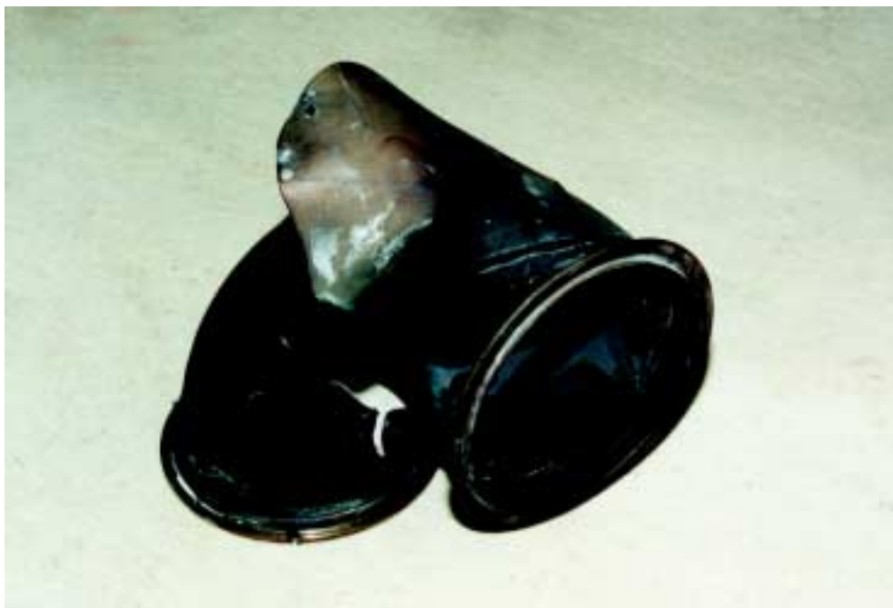
Fot. 1. Pęknięte wejściowe (lewe) przyłącze magistrali nadmuchu klap
