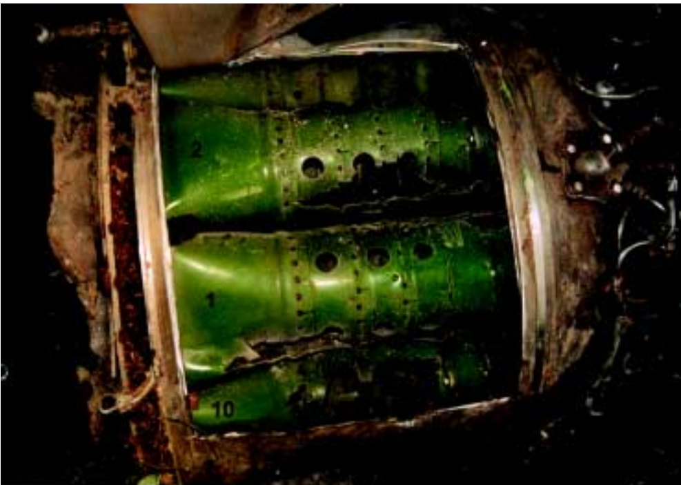
Fot. 3. Wypalone rury żarowe nr 1, 2 i 10 komory spalania silnika
