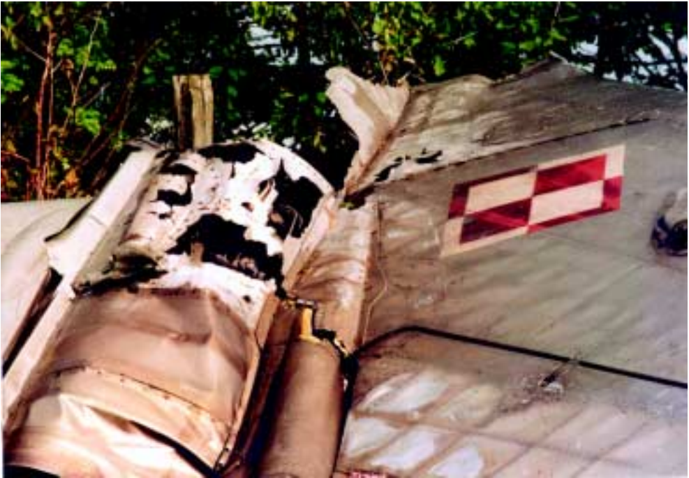
Fot. 2. Wypalenia w lewej tylnej części kadłuba samolotu
