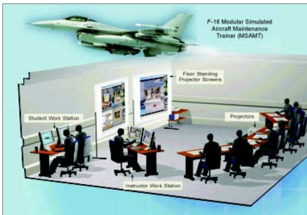
Rys. 3. Wizja modułowego symulatora do szkolenia personelu technicznego MSAMT (Modular Simulated Aircraft Maintenance Trainer)
