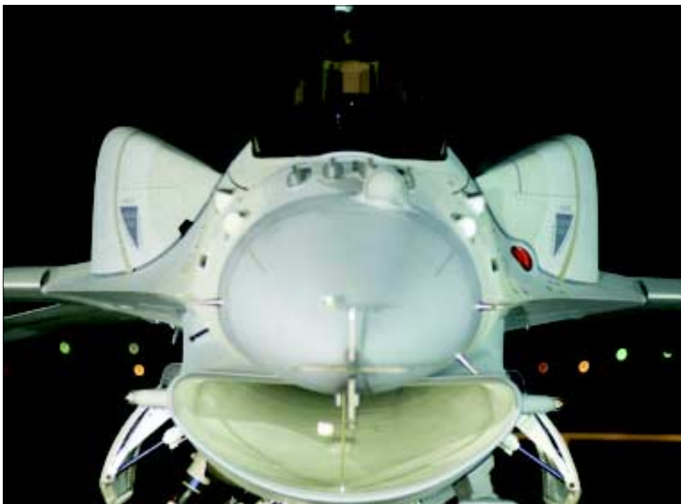
Fot. 1. Tak będzie wyglądał polski F-16 . Na zdjęciu widoczne dodatkowe zbiorniki paliwa (ang. Conformal Fuel Tank – CFT)
