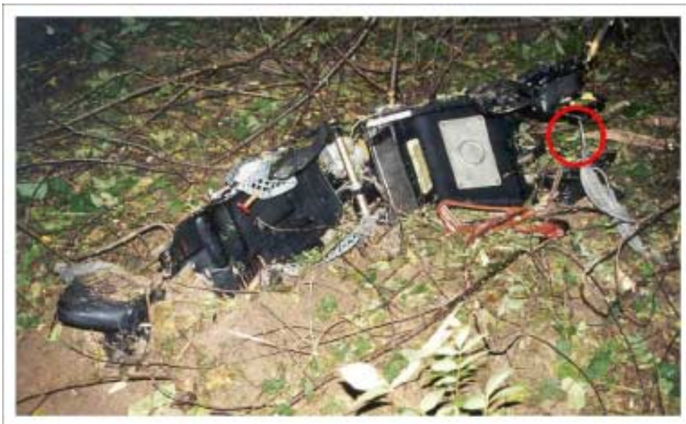
Fotel katapultowy (widoczne niedociągnięte linki chwytników nóg)
