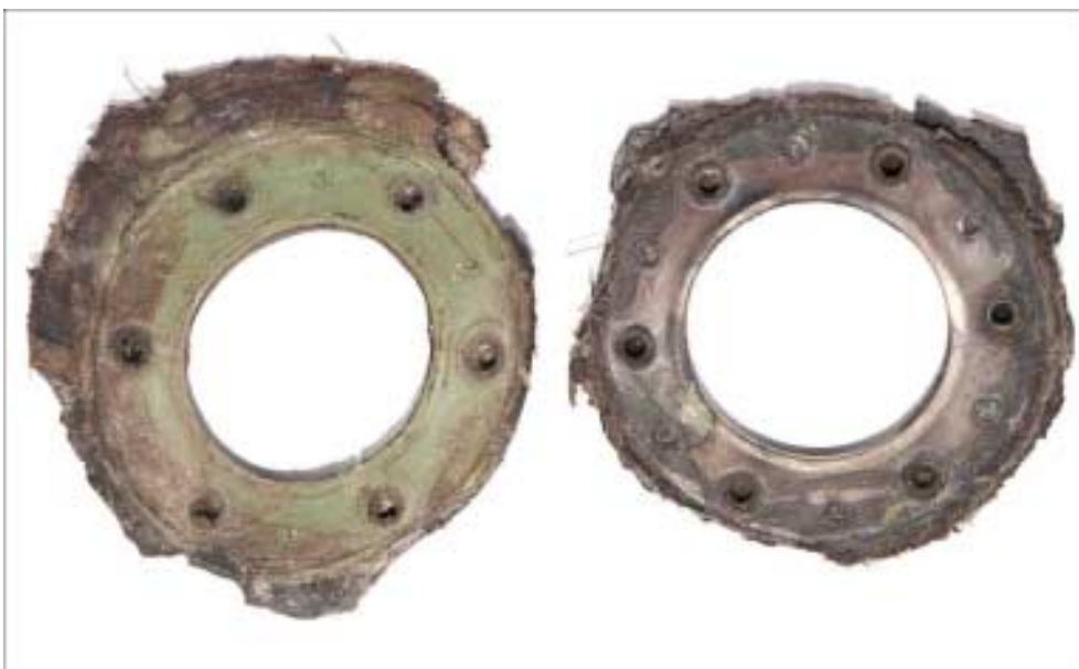
Kołnierze gumowych zbiorników paliwa (z prawej – kołnierz przyłącza, z którego prawdopodobnie nastąpił wyciek)
