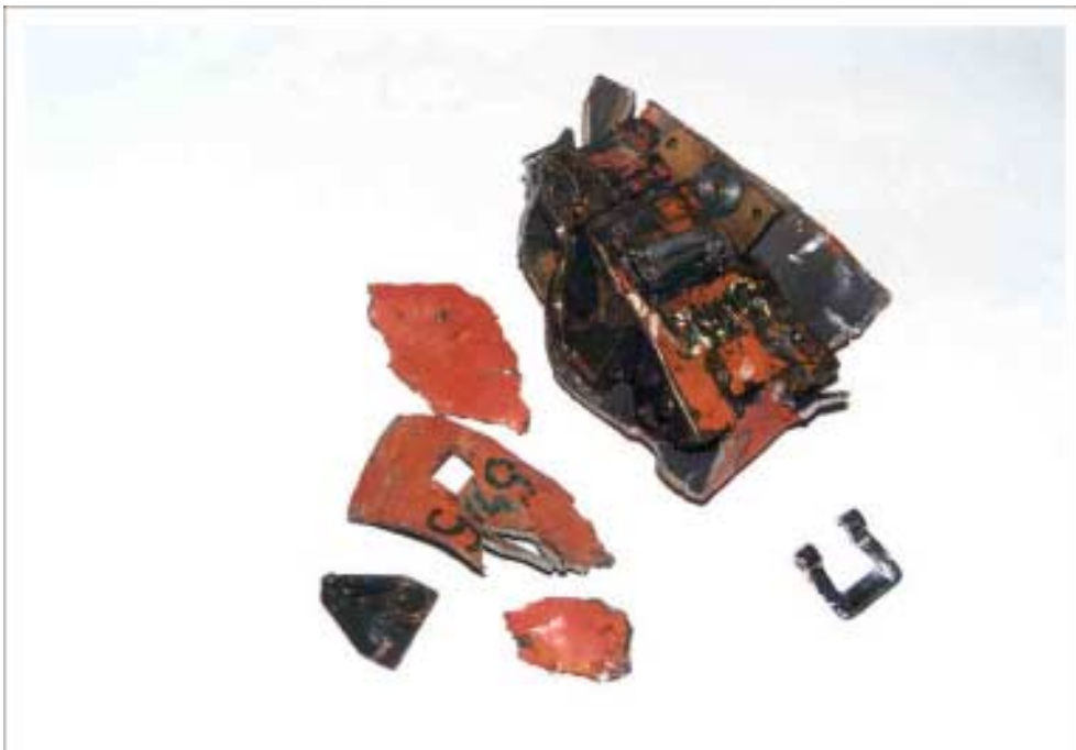
Odnaleziona kaseta rejestratora parametrów lotu SARPP-12GM
