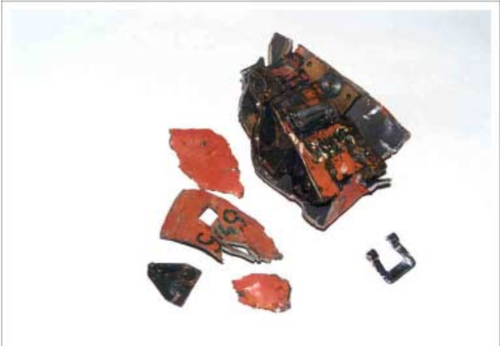
Odnaleziona kaseta rejestratora parametrów lotu SARPP-12GM
