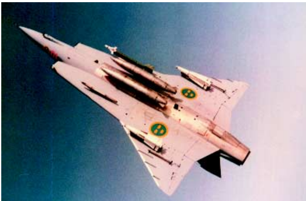
Bezogonowy samolot J 35F Draken ze skrzydłami w układzie podwójnej delty. Fot. „World Air Power Journal”
