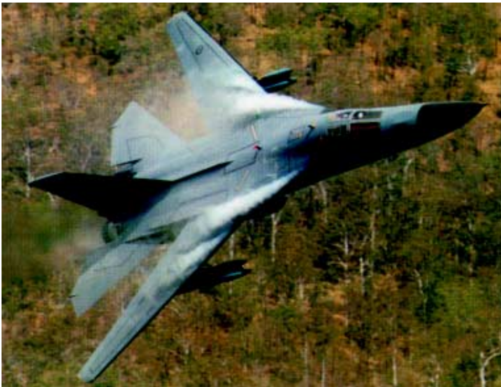
F-111 amerykańskiej firmy General Dynamics – pierwszy samolot o zmiennej geometrii skrzydeł. Fot. G. D.
