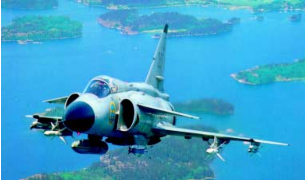
Szwedzki myśliwiec Saab JA 37 Viggen – pierwszy w świecie samolot z przednim usterzeniem (typu „kaczka”) i silnikiem wyposażonym w odwracacz ciągu. Fot. Saab
