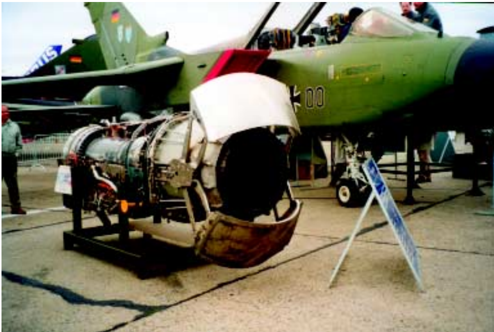
Tornado – jeden z dwóch na świecie samolotów myśliwskich (drugi Viggen ), którego silniki RB-199 wyposażone są w odwracacze ciągu. Fot. J. Grzegorzewski
