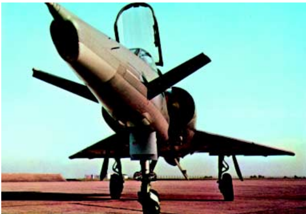
Francuski myśliwski samolot doświadczalny Milan (rozwinięty z Mirage III ) z dodatkowymi przednimi skrzydełkami – wypuszczanymi lub chowanymi, o masie startowej 14 500 kg, osiągający prędkość lotu Ma < 2 . Fot. U.S.I.A.S.
