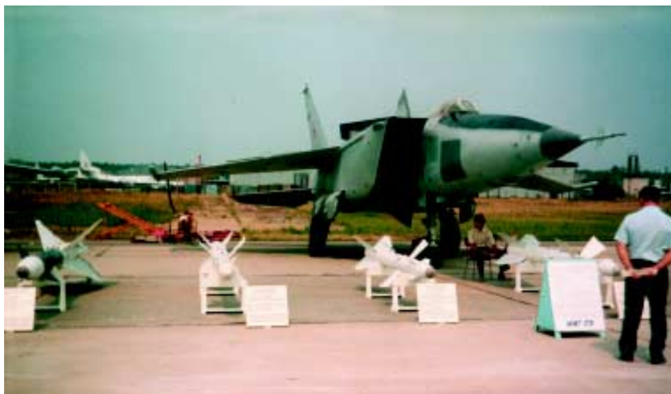
MiG-25 (zgłoszony do FAI jako E-266M ) – najszybszy samolot myśliwski świata. Wyprodukowano go w liczbie 1112 szt. Na tym samolocie M. Komarow 5 października 1967 r. ustanowił rekord świata prędkości w obwodzie zamkniętym 500 km, wynoszący 2981,5 km/h, a A. Fiedotow 31 sierpnia 1977 r. osiągnął wysokość 37 650 m. Fot. J. Grzegorzewski
