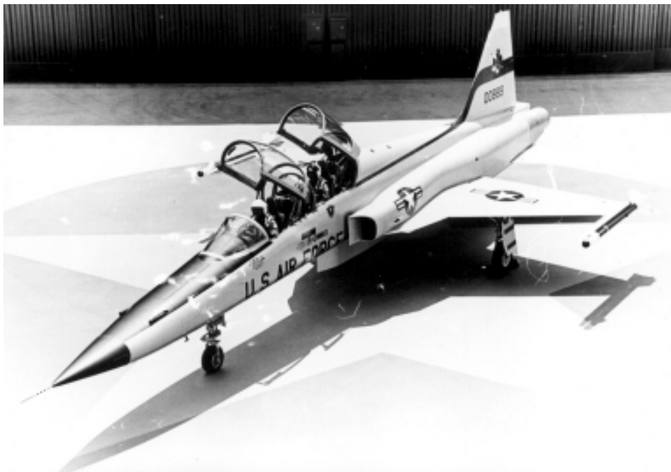
Samolot myśliwski F-5 (w wersji dwumiejscowej F-5F ) ze skrzydłami pasmowymi, opracowany zgodnie z tzw. regułą pół. Fot. Northrop
