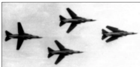
Polskie samoloty MiG-23F na Air Show Poznań '91. Skrzydła ustawione pod różnymi kątami: w pierwszym samolocie z prawej strony – 16°, w dwóch następnych – 45°, w ostatnim – 72°. Fot. J. Grzegorzewski
