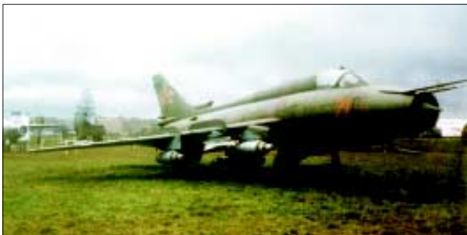
Muzealny egzemplarz Su-22 uzbrojony w zasobniki-wyrzutnie niekierowanych pocisków raketowych UB-32-57 , kierowane pociski R-60M klasy powietrze-powietrze i 500-kilogramową bombę (pod kadłubem). Fot. J. Grzegorzewski
