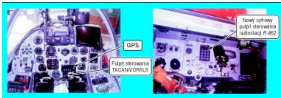
Nowe elementy w kabine pilotów wyposażonego samolotu Su-22M4. Fot. WZL
