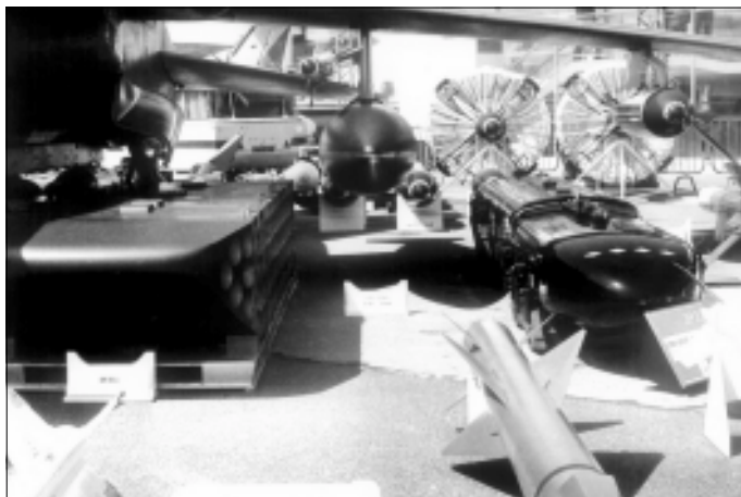
Tornado IDS przenoszą różnorodne uzbrojenie podwieszane, m.in. zasobniki kasetowe MW-1 (niemiecki) i JP 231 (brytyjski) z subamunicją o różnym przeznaczeniu, hamowane bomby kasetowe BL 755 (brytyjskie), bomby klasyczne (w głębi). Fot. J. Grzegorzewski
