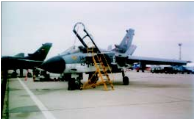
Niemiecki Tornado IDS z uniesioną osłoną kabiny i wypuszczonymi hamulcami aerodynamicznymi w tyle kadłuba. Nad gołonią podwozia przedniego widoczny jest wylot działka. Fot. J. Grzegorzewski
