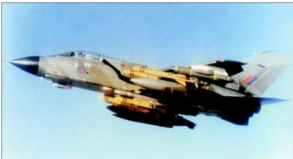
Brytyjski Tornado GR 4 przenosi pociski przeciwradiolokacyjne ALARM pod skrzydłami i kadłubem. Fot. BAE Systems
