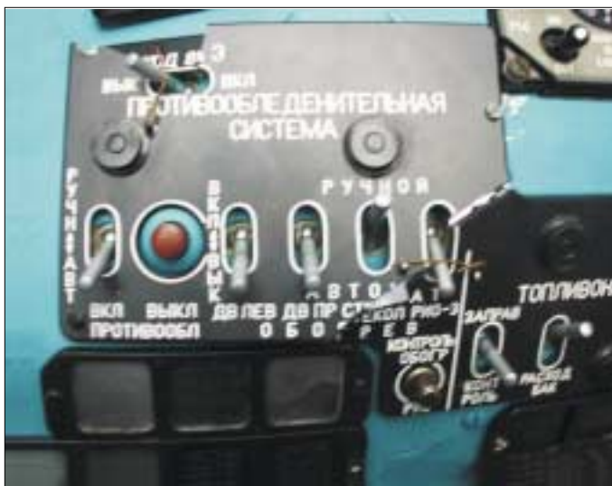
Fot. 3. Położenie dźwigni przełączników i wyłączników w kabynie pilotów śmigłowca
