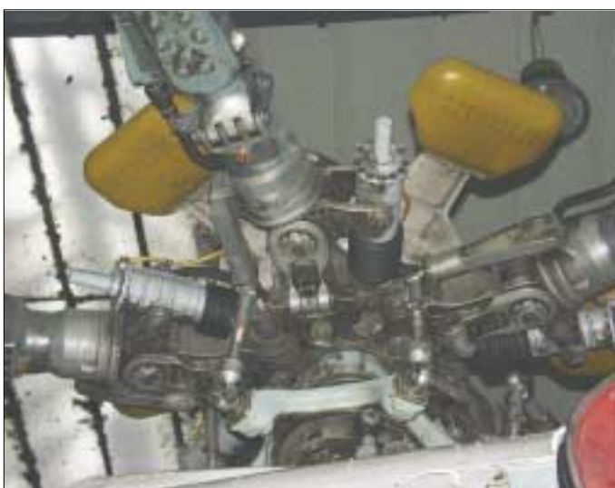
Fot. 2. Sprawna piasta wirnika nośnego – łopaty wirnika nośnego znajdują się w położeniu neutralnym
