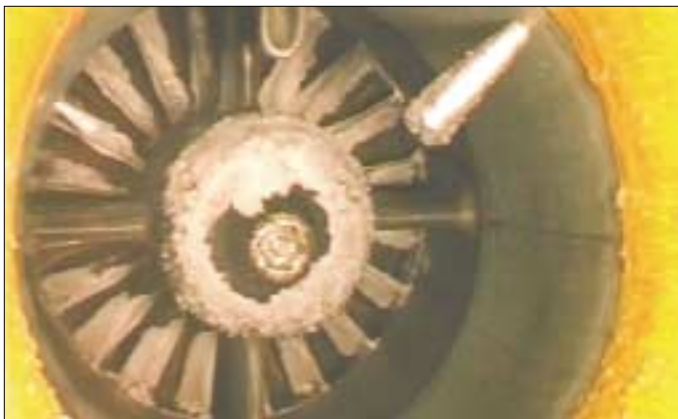
Fot. 4. Oblodzone łopatki wlotowego aparatu kierującego sprężarki podczas próby na hamowni
