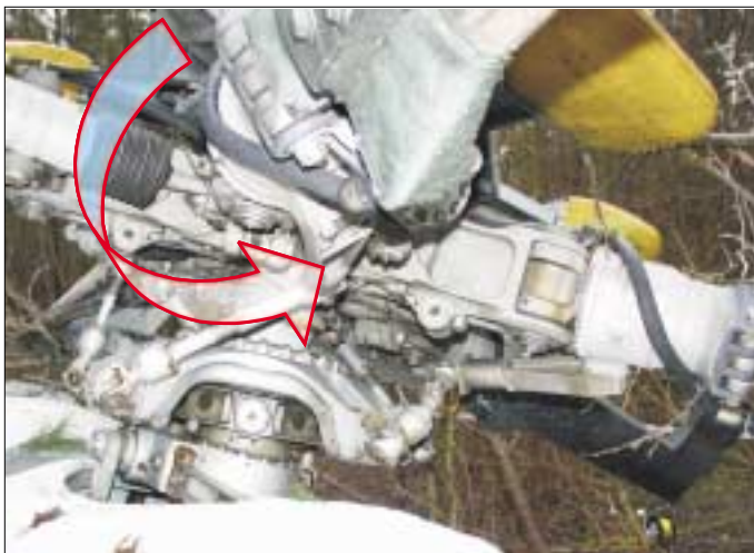
Fot. 1. Łopaty wirnika nośnego obrócone o kąt -135^\circ względem przegubów osiowych piasty wirnika nośnego. Strzałką zaznaczono kierunek obrotu
