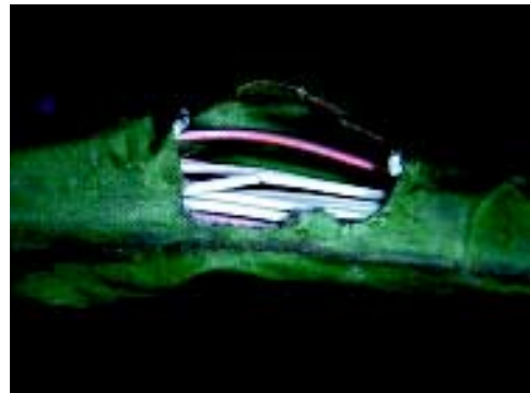
Wiązka elektryczna uszkodzona przez szczury
