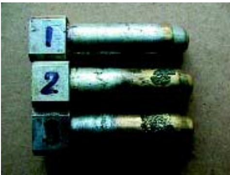
Elektryczne kołki akumulatorowe o różnym stopniu zużycia
