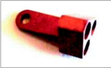
Półfabrykat końcówki przewodu do prądnicy GS-18 wykonany w ITWL
