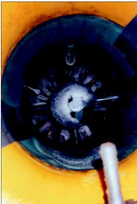
Oblodzenie wlotu turbinowego silnika śmigłowca. Zerwanie części powłoki lodowej z ciała centralnego doprowadziło do zgaśnięcia silnika
